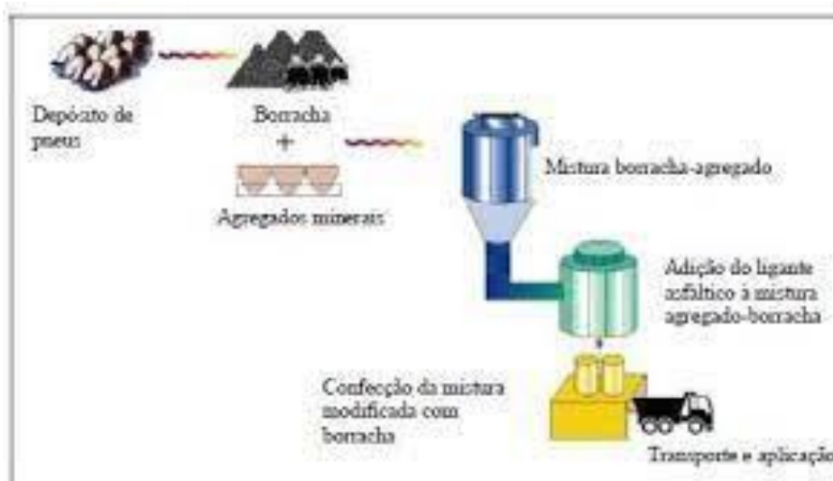
Figura 4 Esquema de fabricação do asfalto-borracha via seco pelo processo de mistura – Fonte: Dantas Neto et al (2003)
